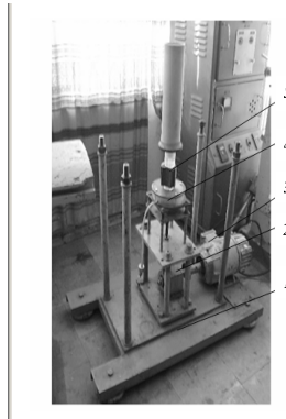
Мал. 3. Загальний вигляд кавітаційно-магнітної установки
