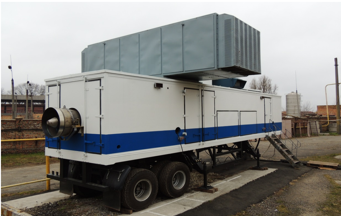
Рисунок 1. Зовнішній вигляд пересувної автоматизованої електростанції ПАЕС-2500
