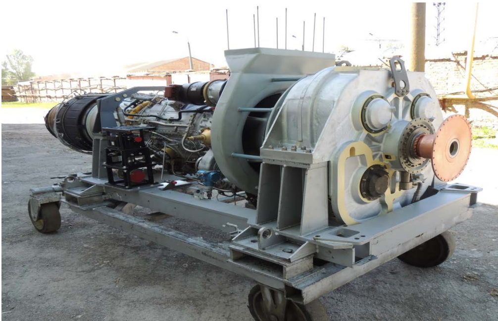
Рисунок 2. Газотурбінний привід ГТС МС -2,5 з двигуном АІ-20
